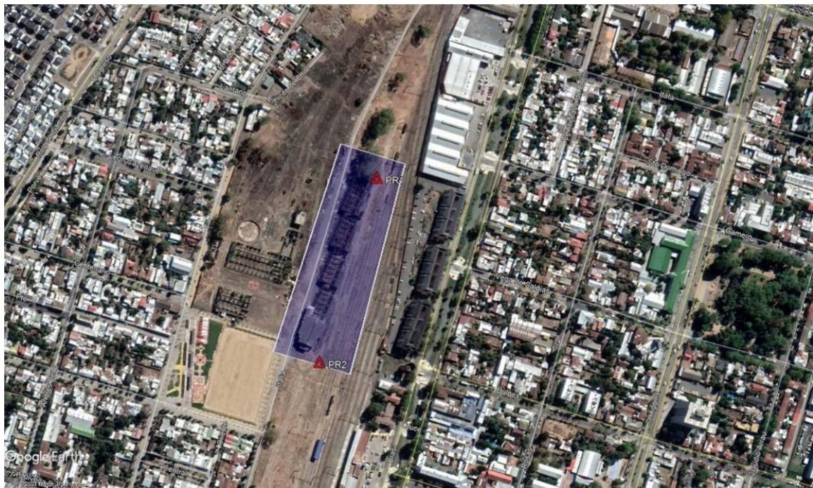
Este levantamiento topográfico está georreferenciado mediante sistema GNSS geodésico, el cual trabaja bajo el datum WGS84 huso 18s y modelo geoidal EGM08 que nos entrega alturas orto métricas.
