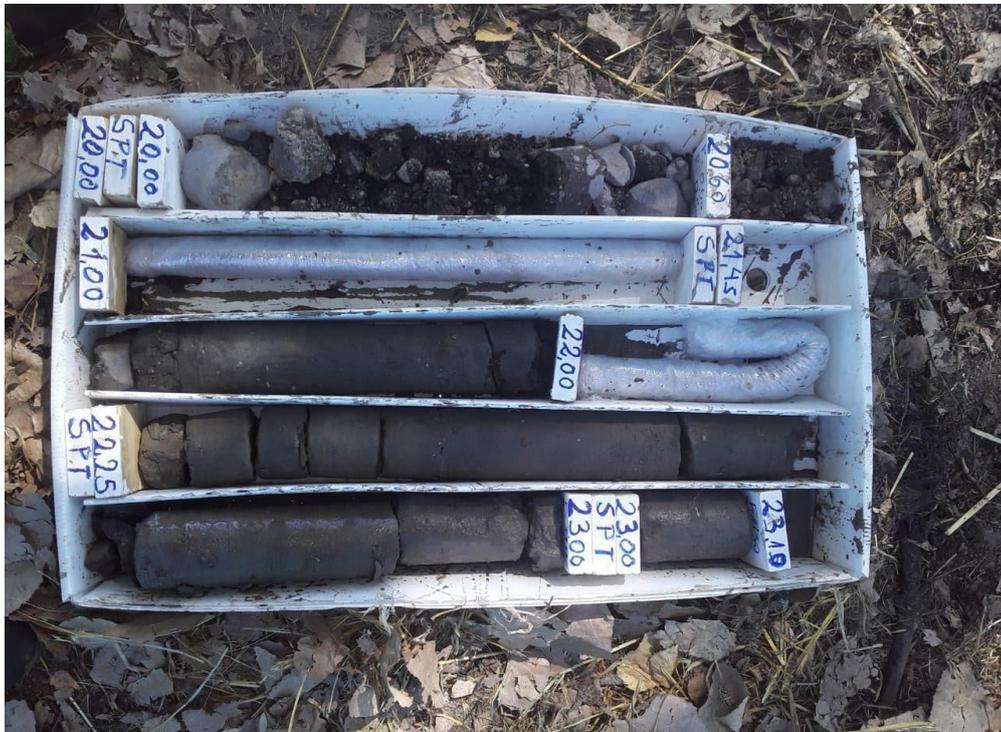
Figura 25- Fotografía 8, 20.00 - 23.00 mts, sondaje S-1 Proyecto Ultraestación Chillán.
