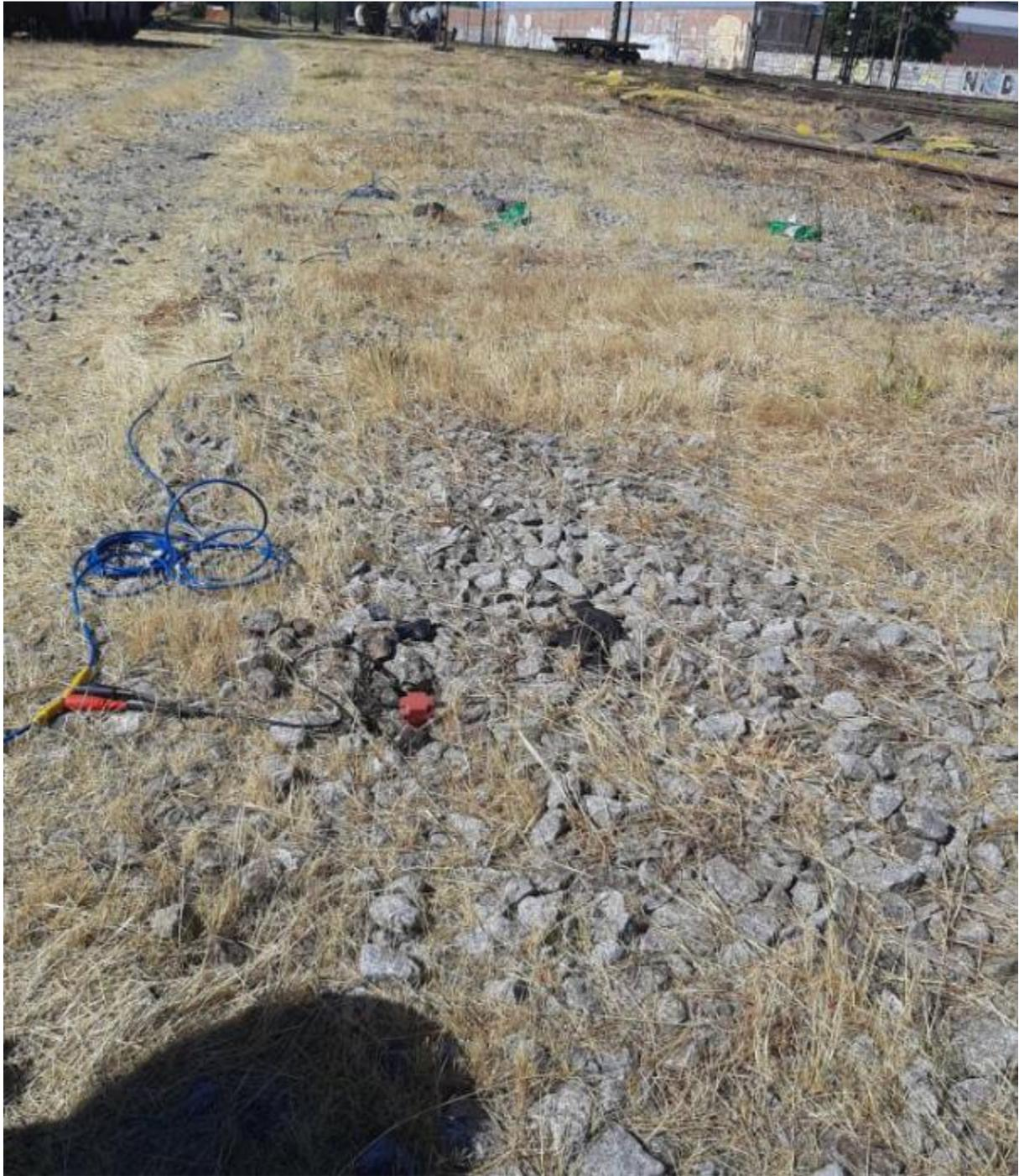
*Figura 13. Fotografía durante la ejecución de ensayo ReMi en sector 2.*
