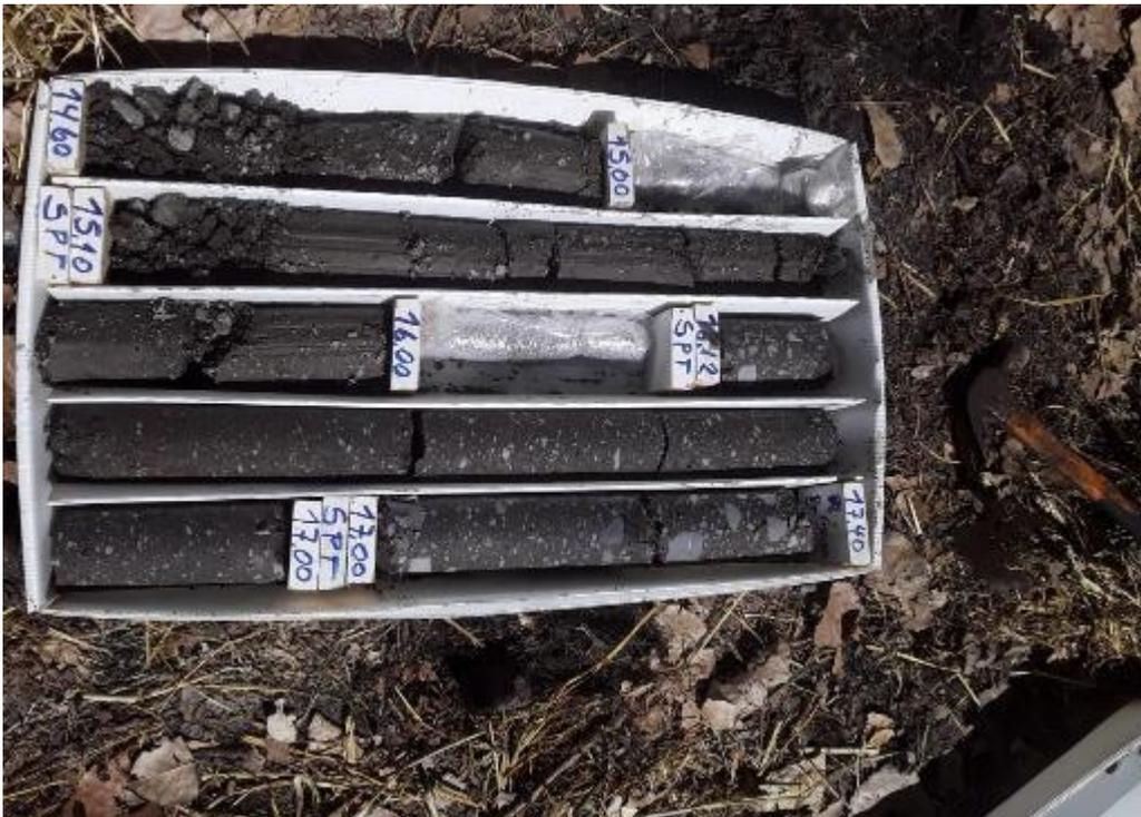
Figura 23- Fotografía 6, 14.60 - 17.00 mts, sondaje S-1 Proyecto Ultraestación Chillán.
