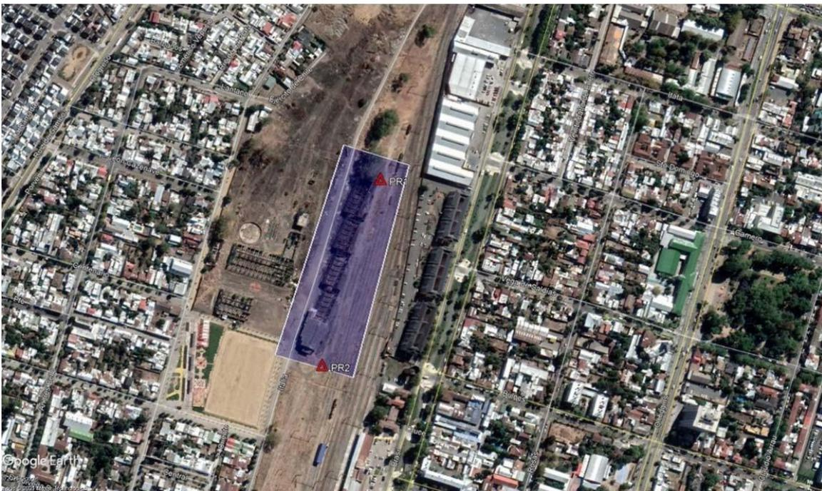
Este levantamiento topográfico esta georreferenciado mediante sistema GNSS geodésico, el cual trabaja bajo el datum WGS84 huso 18s y modelo geoidal EGM08 que nos entrega alturas orto métricas.
