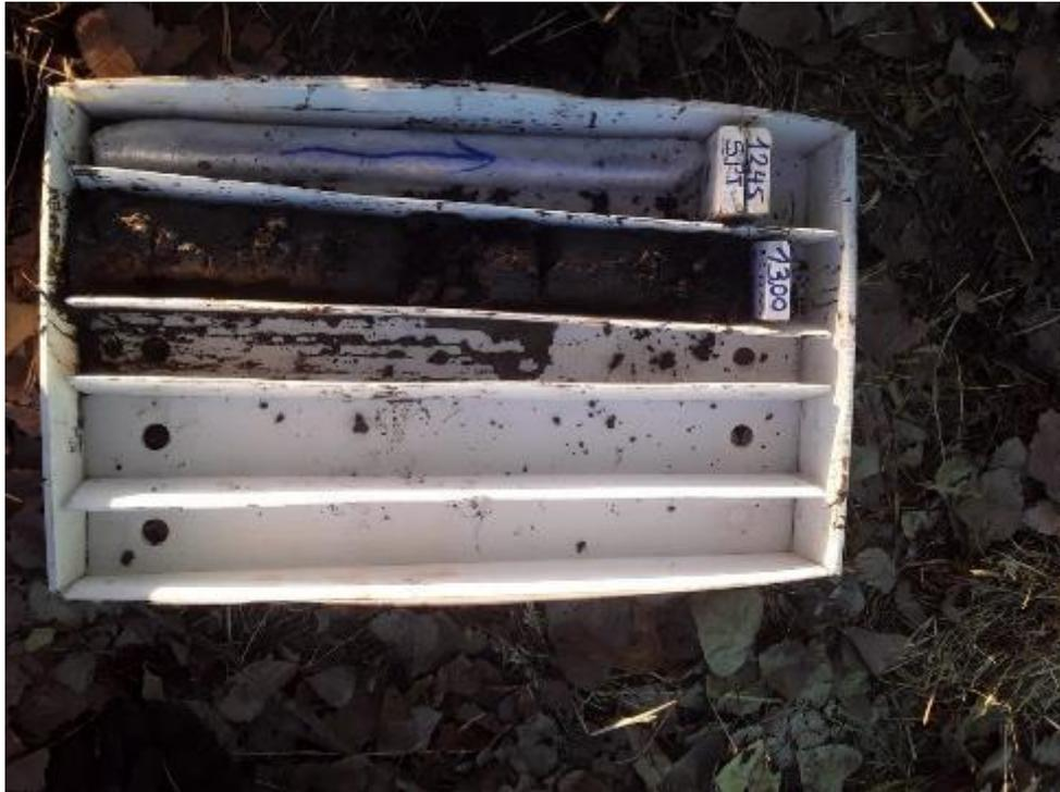
Figura 22- Fotografía 5, 12.45 - 13.00 mts, sondaje S-1 Proyecto Ultraestación Chillán.
