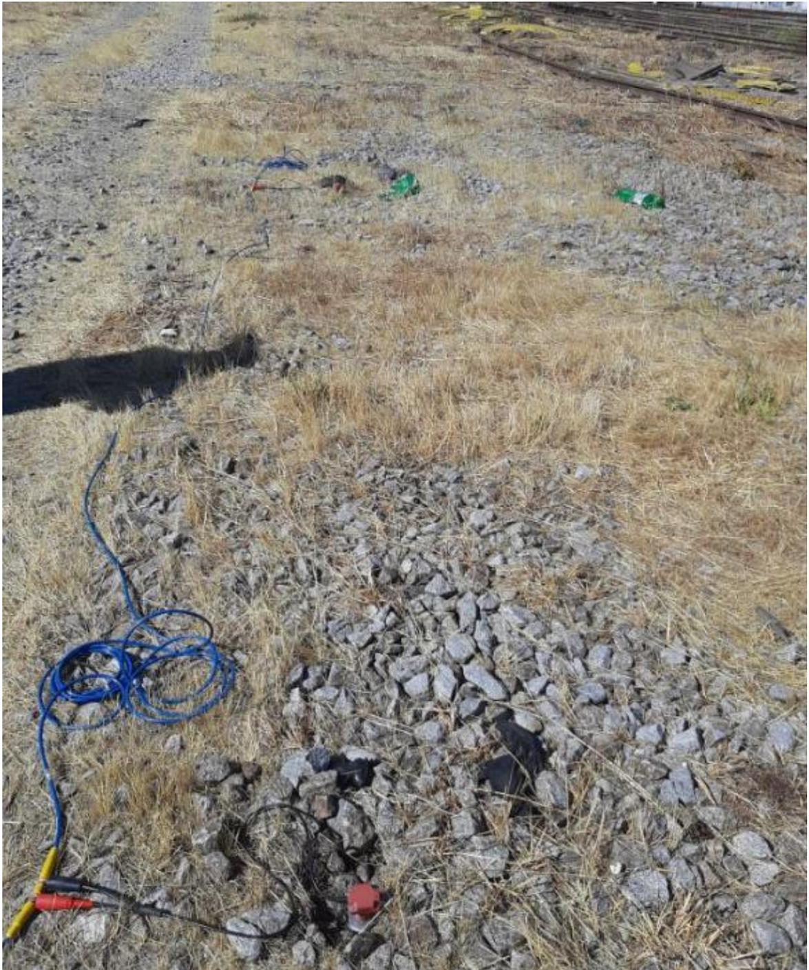
*Figura 12. Fotografía durante la ejecución de ensayo ReMi en sector 1.*
