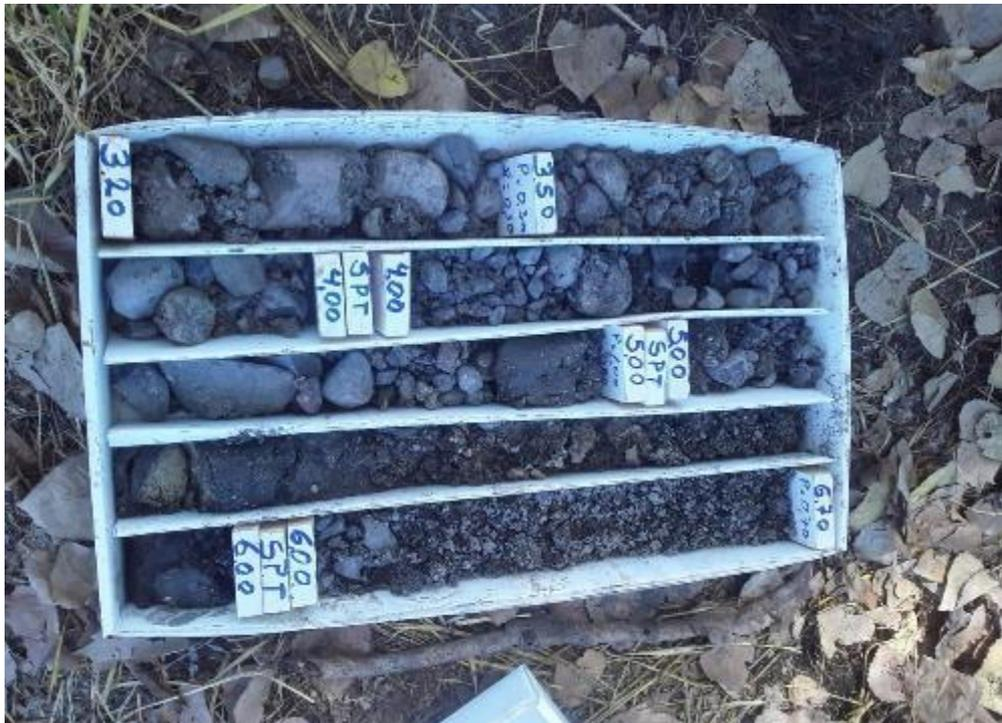
Figura 19- Fotografía 2, 3.20 - 6.70 mts, sondaje S-1 Proyecto Ultraestación Chillán.
