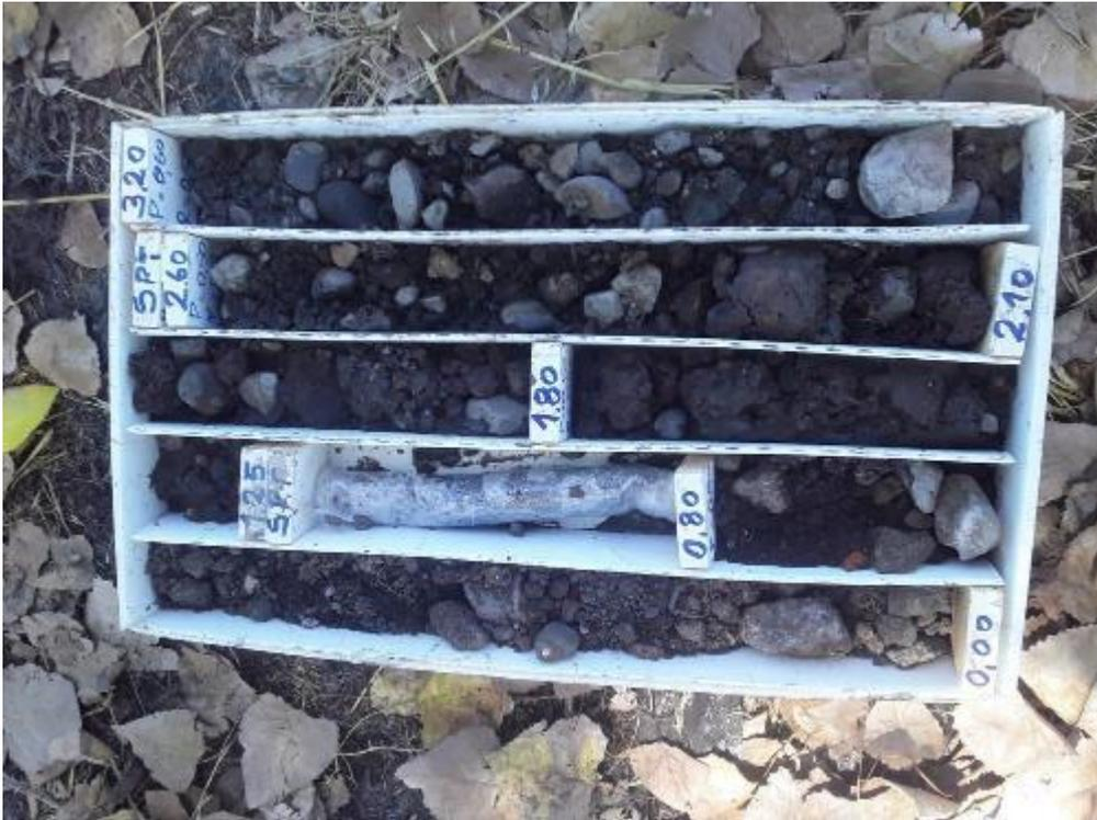
Figura 18- Fotografía 1, 0.00 - 3.20 mts, sondaje S-1 Proyecto Ultraestación Chillán.
