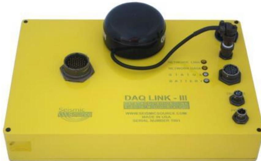
Figura 4. Sismógrafo para Ensayo ReMi de ultima generación utilizado por la empresa KBA-IC.
