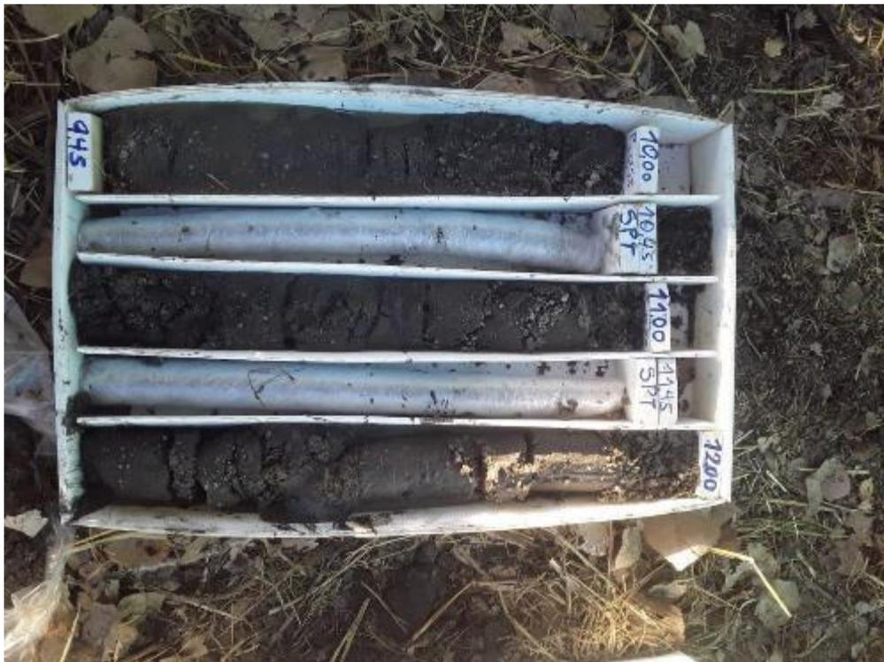
Figura 21- Fotografía 4, 9.45 - 12.00 mts, sondaje S-1 Proyecto Ultraestación Chillán.
