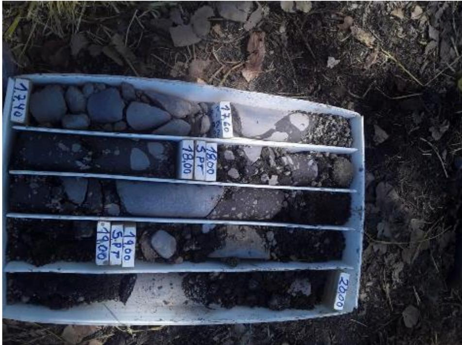
Figura 24- Fotografía 7, 17.40 – 20.00 mts, sondaje S-1 Proyecto Ultraestación Chillán.
