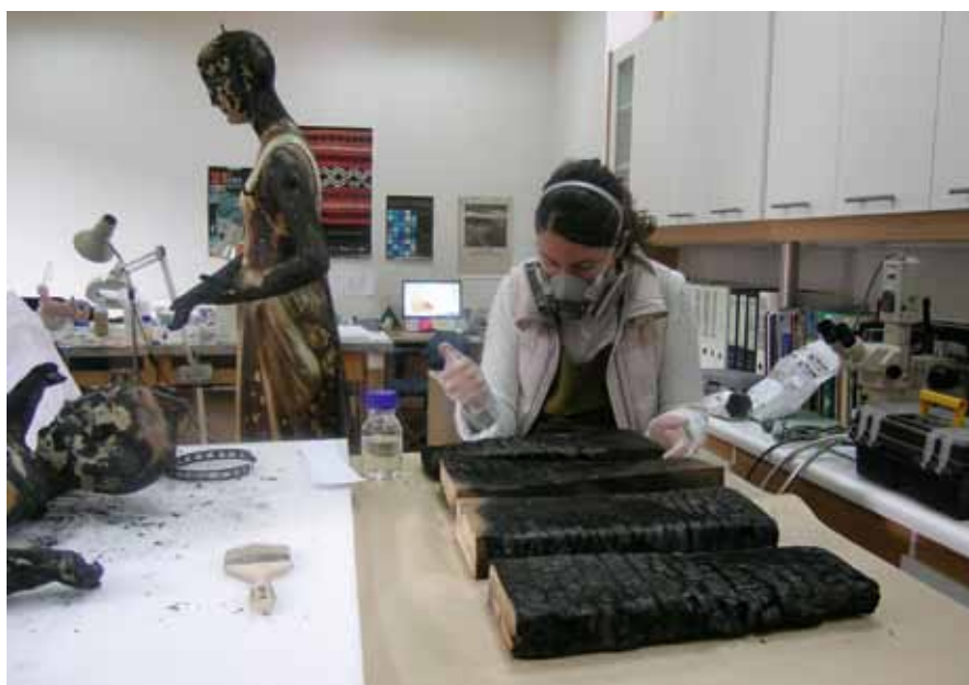
Foto 5. Aplicación de consolidante en prototipos de madera.
